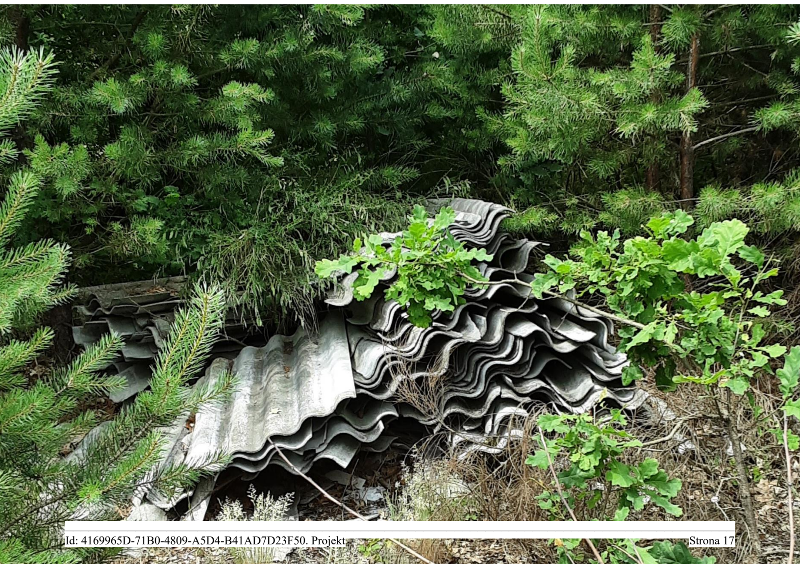
Fot. 4. Nielegalne składowanie wyrobów azbestowych.
